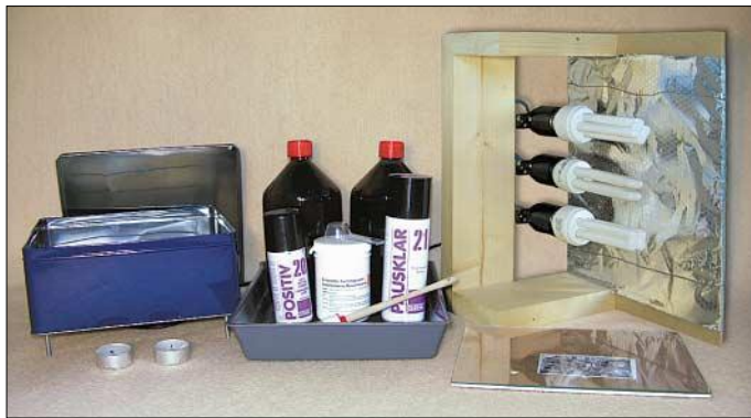
Bild 1: Komplett Ausrüstung zur Herstellung von Leiterplatten; (v.l.n.r.) Trockenofen, Fotoschale mit Chemikalien, Belichtungsgerät mit Bilderrahmen und Papierlayoutvorlage davor
