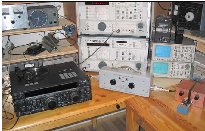
Bild 1: Funkstation OE3HKL mit Messaufbau zur Bestimmung des IP3 bei kleinem Spacing, Details siehe Text
