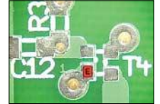
Bild 10: An dieser Stelle ist T4 einzulöten, siehe Text.
