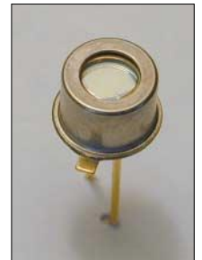
Bild 2: Mit dem UV-Sensor EryF lässt sich die Sonnenbadedauer bis zum Sonnenbrand für verschiedene Hauttypen leicht abschätzen.
