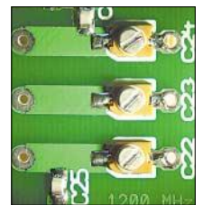
Bild 12: Stellung der Trimmer C22 bis C24
