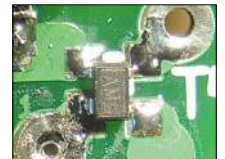
Bild 11: T4 fertig eingelötet Fotos: DG4RBF
