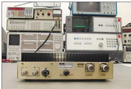
Bild 2: PA vor dem Messplatz, von der Rückseite aus gesehen. In der Mitte ist deutlich der Drehknopf für die VOX-Abfallzeit zu erkennen. Fotos: DL2KCK
