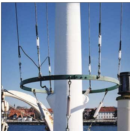
Untere Befestigung und Speisepunkt der umgebauten Reusenantenne Fotos: DL6AKC
